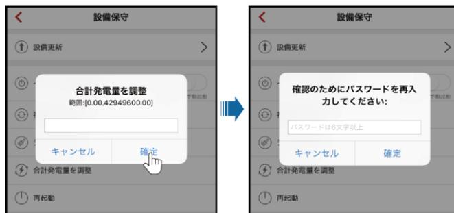
総エネルギー収率の調整:インバータのエネルギー収率の初期値を指定します。このパラメータは、SUN2000L を交換する場合に使用されます。新しい SUN2000L のエネルギー収率の初期値を古い SUN2000L の総エネルギー収率に設定し、累積エネルギー収率の統計値の連続性を確保します。
