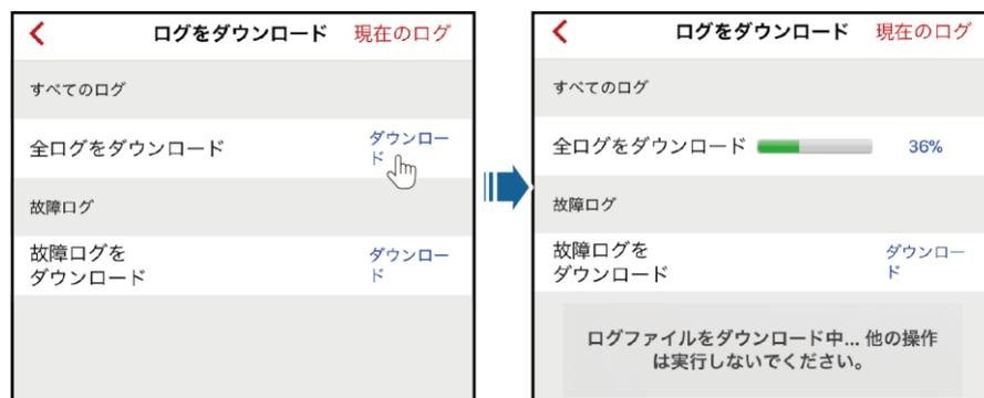
**ステップ 2** ログのダウンロード後、**現在のログ**を選択することで、ログの一覧にアクセスしてダウンロードしたログを確認できます。ログをメールで送信したり、削除したりするには、右上隅の**選択**をタップし、メールで送信するログを選択します。
